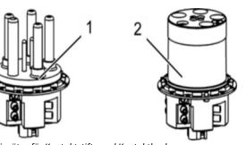
Abb. 14: Einsätze für Kontaktstifte und Kontaktbuchsen
