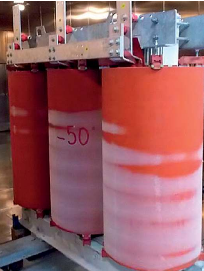
Transformatory Tesar podczas testów klimatycznych
